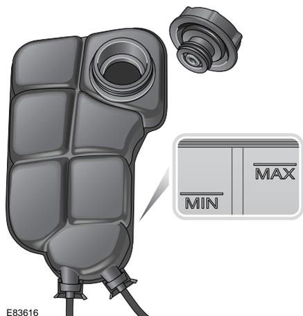
确保冷却液液位位于膨胀罐侧壁上的液位指示标记之间。
