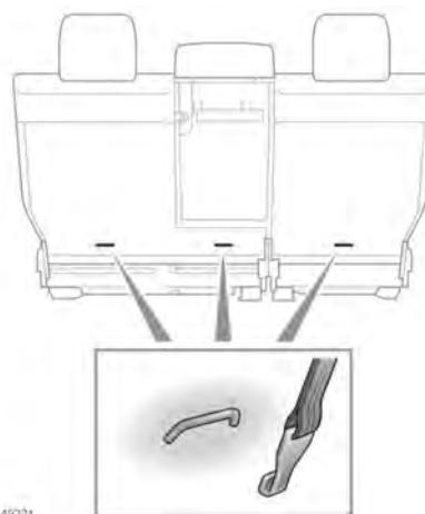
在车辆第二排座椅架的背面设有锚具点。它们用于固定儿童座椅或约束系统的系带。
