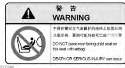
此符号（粘贴在乘客侧遮阳板上）目的在于提醒使用者注意：当前排乘客安全气囊已安装并启用时，不要在前排乘客座椅上使用后向儿童座椅。
