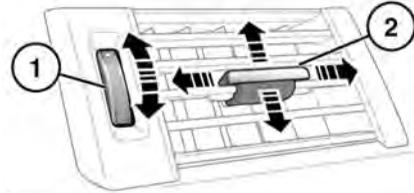
Die Belüftungsdüsen können auf folgende Weise geöffnet werden:
