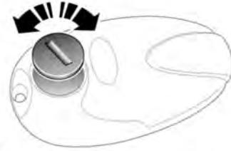
Die Fernbedienung mit der Rückseite nach oben halten und z. B. mit einer Münze die Batterieabdeckung aufdrehen. Die Abdeckung abnehmen, um an die Batterie zu gelangen. Die alte Batterie entnehmen und eine 3,3-V-Ersatzbatterie (Typ CR1/3N) unter Beachtung der korrekten Polarität einlegen. Die Abdeckung wieder aufsetzen und zum Schließen drehen.
