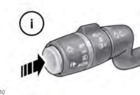
Der Bordcomputer kann unterschiedliche Informationen für den Fahrer anzeigen. Durch einmaliges kurzes Drücken (höchstens 1 Sekunde) der Taste **i** wird das Bordcomputertermenü auf der Instrumententafel angezeigt. Verfügbare Optionen:
