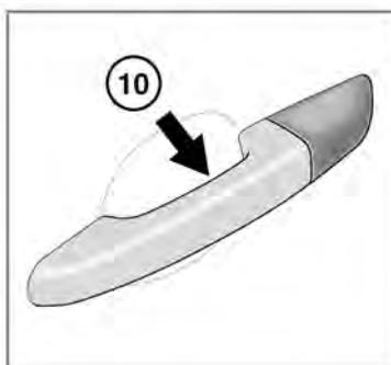
1. Verriegeln: Zum Verriegeln des Fahrzeugs drücken. Das Fahrzeug wird einfach verriegelt. Bei Fahrzeugen für bestimmte Märkte wird das Fahrzeug durch ein zweites Drücken doppelt verriegelt. Siehe **21, EINFACHVERRIEGELUNG, 21, DOPPELVERRIEGELUNG**. Wenn die elektrisch ein-/ausklappbaren Spiegel vorhanden und aktiviert sind, klappen sie ein. Siehe **88, AUSSENSPIEGEL**. Gedrückt halten, um die Komfortschließung zu aktivieren. Siehe **24, KOMFORTSCHLIESSUNG**.
