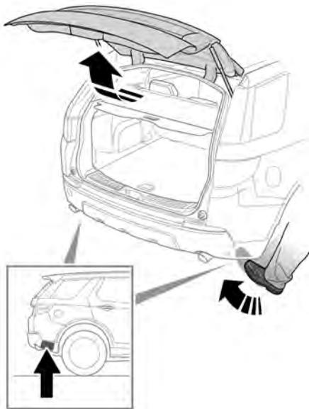
Bei ausgeschalteter Zündung an das Fahrzeugheck herantreten und den Fuß ein bis zwei Sekunden lang in einer glatten Bewegung nach oben ziehen, bis er sich unterhalb eines der hinteren Sensorbereiche befindet. Wenn das Fahrzeug eine nach oben gerichtete Bewegung erkennt, blinken die Heckleuchten und die Heckklappe wird betätigt. Wenn eine akustische Warnung ausgegeben wird, bewegt sich die Heckklappe nicht.
