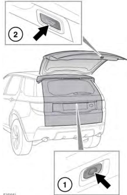
1. Heckklappe öffnen/schließen: Drücken, um die Heckklappe zu öffnen, anzuhalten, die Richtung zu wechseln oder zu schließen.
