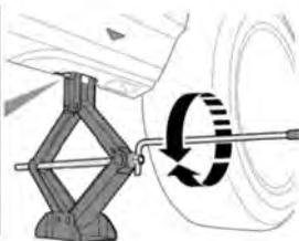
1. Prima di sollevare il veicolo, utilizzare la chiave a tubo per allentare i dadi della ruota da sostituire con un mezzo giro in senso antiorario.
