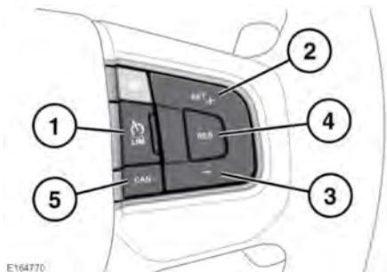
1. **LIM:** Drücken, um zwischen ASL und Geschwindigkeitsregelung umzuschalten. Die Warnleuchte der Geschwindigkeitsregelung leuchtet auf, um zu bestätigen, dass die Geschwindigkeitsregelung aktiviert wurde. Siehe **75, GESCHWINDIGKEITSREGELUNG (GRÜN)**.
