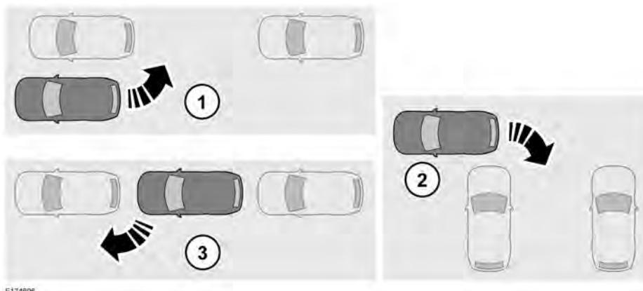
La asistencia al estacionamiento facilita las maniobras de entrada y salida del estacionamiento en paralelo y en batería. La ayuda al estacionamiento toma el control del sistema de dirección del vehículo para maniobrar este.
