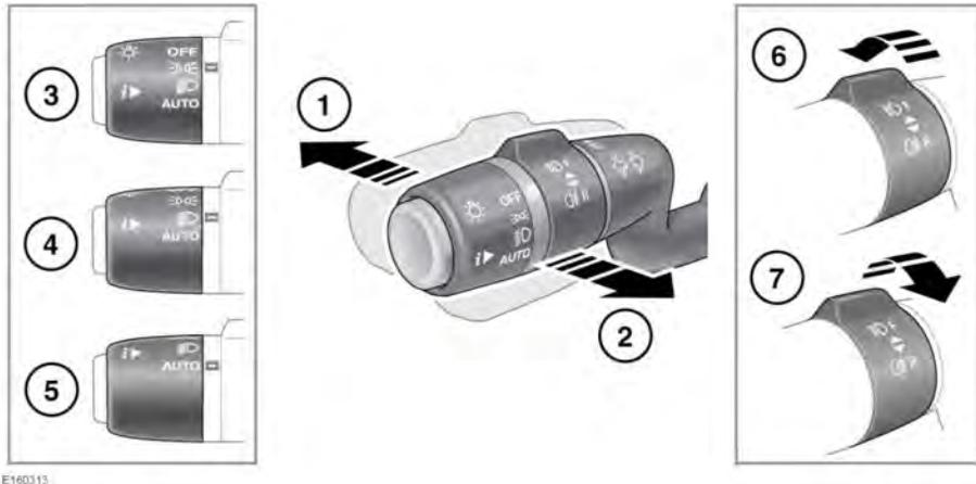
1. Con los faros encendidos, empuje el mando y aléjelo del volante para encender la luz de carretera. El testigo se enciende en el cuadro de instrumentos. Consulte **69, LUZ DE CARRETERA (AZUL)**.
