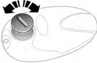
Coloque la parte posterior del mando a distancia hacia arriba y utilice una moneda o un objeto similar para girar la tapa de la pila. Levante la tapa para dejar a la vista el compartimento de la pila. Retire la pila usada, asegúrese de que se mantiene la polaridad correcta e introduzca una pila CR1/3N nueva de 3,3 voltios. Vuelva a colocar la tapa y gírela para bloquearla en la posición de cierre.
