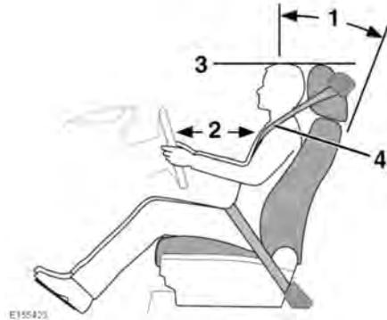
1. Siéntese en posición erguida con la base de la columna vertebral posicionada lo más atrás posible. Para garantizar las máximas ventajas del cinturón de seguridad en caso de accidente, no incline el asiento en exceso.
