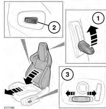
Para abatir el respaldo del asiento hacia delante, levante la palanca de bloqueo (1).
