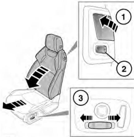
Para abatir el respaldo del asiento hacia delante, levante la palanca de bloqueo (1).
