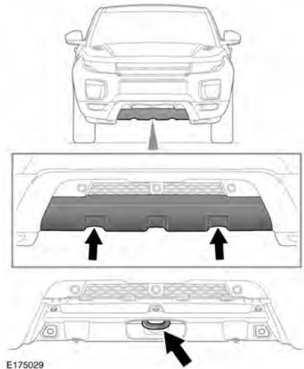
La argolla de remolque está situada detrás de un panel en el parachoques.
