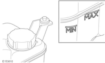
Verifique que se mantiene el nivel de refrigerante entre las marcas indicadoras **MIN** y **MAX** en el lateral del depósito de expansión.
