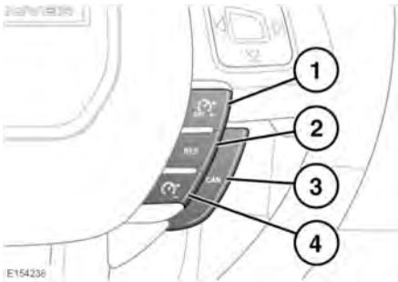
1. **SET+** (Definir +): pulse para programar la velocidad o aumentar la velocidad programada. El testigo del sistema de control de velocidad se ilumina para confirmar que el sistema está en funcionamiento. Consulte **68, SISTEMA DE CONTROL DE VELOCIDAD (VERDE)**.
