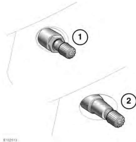
Räder mit TPMS sind daran zu erkennen, dass Ventile und Sicherungsmuttern aus Metall sind (1). Alle Land Rover Räder ohne TPMS haben ein Ventil aus Gummi (2).
