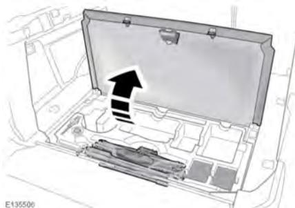
**5-Sitzer:** Der Werkzeugsatz befindet sich unter einer Abdeckung im Boden des Laderaums.
