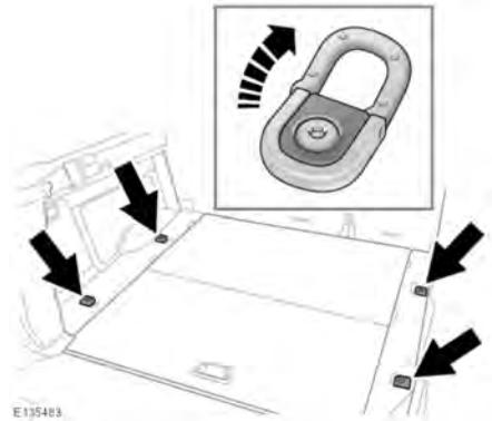
Zum sicheren Verstauen von großen Gepäckgegenständen befinden sich vier Befestigungspunkte auf dem hinteren Laderaumboden.
