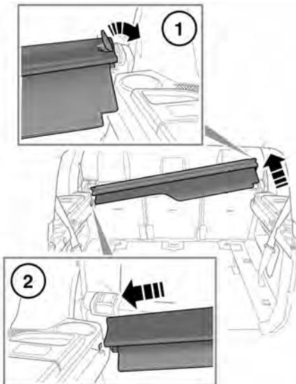
1. Zum Abnehmen der Laderaumabdeckung, die Schaltwippe am Ende der Abdeckung anheben, und die Baugruppe von den Befestigungspunkten weg heben.
