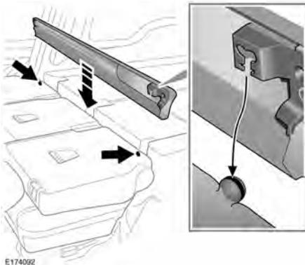
Zum Verstauen der Laderaumabdeckung die Baugruppe absenken, bis sie fest in den Befestigungselementen an der Rückseite der zweiten Sitzreihe sitzt.
