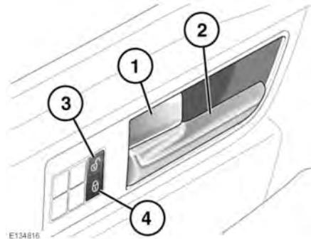
1. Zum Verriegeln drücken. Betätigen Sie einen der Vordertür-Verriegelungshebel, um alle Türen zu verriegeln. Jede Fondtür kann einzeln verriegelt werden.
