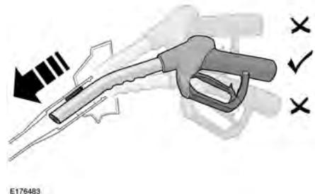
Einige Fahrzeuge mit Dieselmotor verfügen über eine aktive Fehlbetankungssicherung. Dabei handelt es sich um eine Metallklappe im Einfüllstutzen, die verhindert, dass der Tank mit dem falschen Kraftstoff betankt wird, z. B. Benzin. Die Metallklappe wird sichtbar, wenn der Tankdeckel entfernt wird. Die aktive Fehlbetankungssicherung entsperrt sich automatisch, wenn eine passende Diesel-Zapfpistole wie abgebildet vollständig und gerade in den Kraftstoffeinfüllstutzen des Fahrzeugs eingeführt wird.
