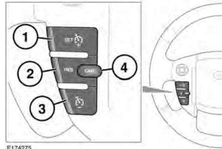
1. **SET+:** Drücken, um die Geschwindigkeit einzustellen oder die voreingestellte Geschwindigkeit zu erhöhen. Die Geschwindigkeitsregelungs-Warnleuchte leuchtet auf, um zu bestätigen, dass die Geschwindigkeitsregelung aktiviert wurde (siehe **66, GESCHWINDIGKEITSREGELUNG (GRÜN)**).
