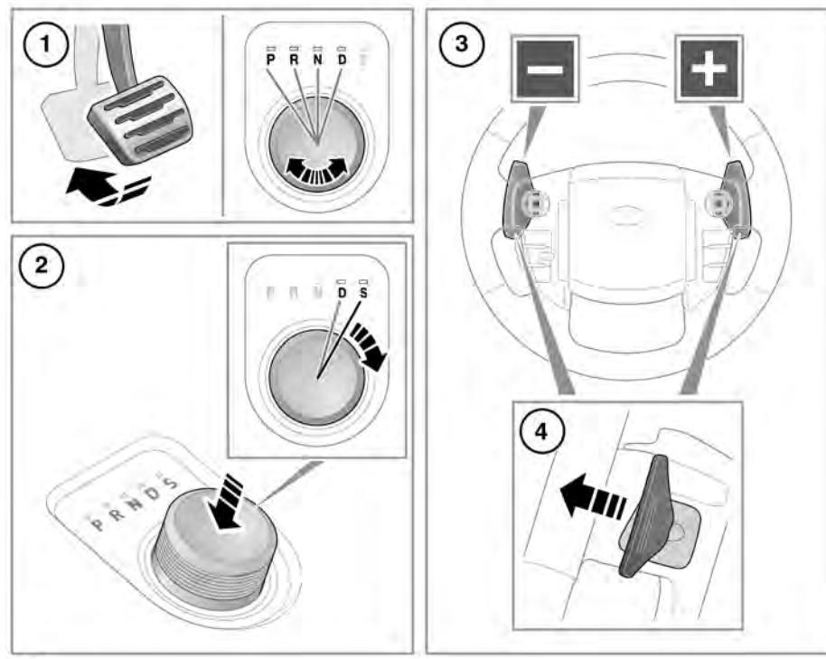
换档旋钮可以朝两个方向旋转。在发动机启动时，换档旋钮从其收起低位升起。
