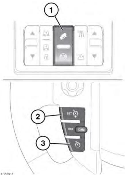
在车辆下坡行驶时，陡坡缓降控制系统 (HDC) 会将车速限制在设定范围内。
