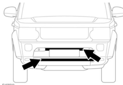
利用软管将清洗水穿过前保险杠（箭头所指）射入，以清除散热器和空调冷凝器上的泥土。
