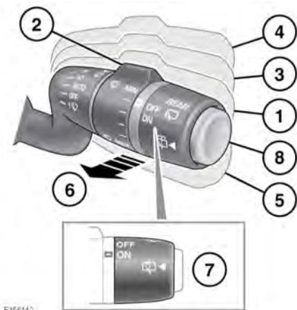
1. 自动雨水感应模式：前雨刮器将自动反应和适应环境雨水情况，并为主要路况选择适应的雨刮器频率。系统的灵敏度可通过旋转旋钮 (2) 调整。
