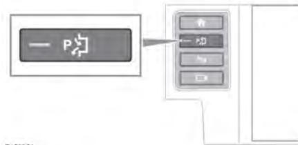
Durch kurzes Drücken der Einparkassistent-Taste wird das System eingeschaltet. Die Kontrollleuchte auf dem Einparkassistent-Schalter leuchtet auf.
