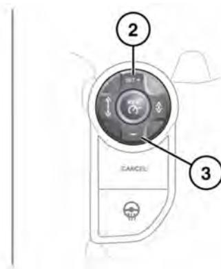
Система управления движением под уклон (HDC) позволяет ограничить скорость автомобиля до заданного значения при движении вниз по склону.
