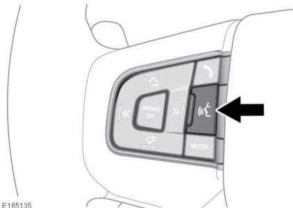
Um eine Sprachsitzung zu starten, die Sprechstaste am Lenkrad kurz drücken. Die **Teleprompter-Liste** wird auf dem Touchscreen angezeigt. Um eine Sprachsitzung abzubrechen, die Sprechstaste gedrückt halten.
