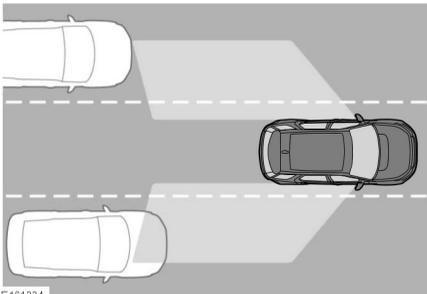
Das BSM-System überwacht den Bereich neben dem Fahrzeug, der vom Fahrer nur schwer einsehbar ist, und dient der Erkennung jedes das Fahrzeug überholenden Verkehrsteilnehmers. Mit Hilfe von Radarsensoren auf beiden Seiten des Fahrzeugs erkennt das System alle überholenden Verkehrsteilnehmer im toten Winkel des Fahrzeugs, während andere Fahrzeuge/Objekte, die sich nicht oder in die entgegengesetzte Richtung bewegen, ignoriert werden.
