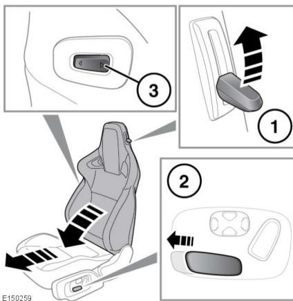
1. Поднимите фиксатор блокировки и наклоните спинку сиденья вперед.
