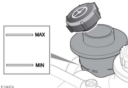
Die Flüssigkeit ist durch die transparente Behälterwand sichtbar.
