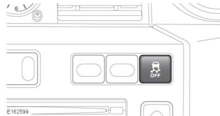
Zur Deaktivierung der DSC die Taste „DSC AUS“ kurz gedrückt halten. Die DSC-OFF-Warnleuchte leuchtet auf. Siehe **32, DYNAMISCHE STABILITÄTSKONTROLLE (DSC) AUS (ORANGE)**. Bei deaktivierter DSC greift auch die Antischlupfregelung (ETC) nicht im normalen Umfang ein, so dass die Räder häufiger durchdrehen können.
