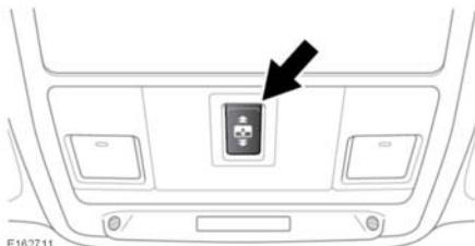
Переключатель открывания/закрывания шторки крыши:
