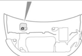
1. Нажмите на защелку крышки в сторону передней части автомобиля.
