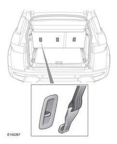
Il veicolo potrebbe essere dotato di punti di ancoraggio sul retro dei telai dei sedili della seconda fila. Utilizzare i punti di ancoraggio per fissare le cinghie dei seggiolini o dei sistemi di ritenuta per bambini.
