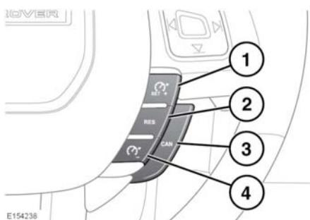
1. **SET+:** premere per impostare la velocità o aumentare la velocità impostata. La spia del comando della velocità di crociera si accende per confermare che il comando è in funzione. Vedere 52, **COMANDO VELOCITÀ DI CROCIERA (VERDE)**.
