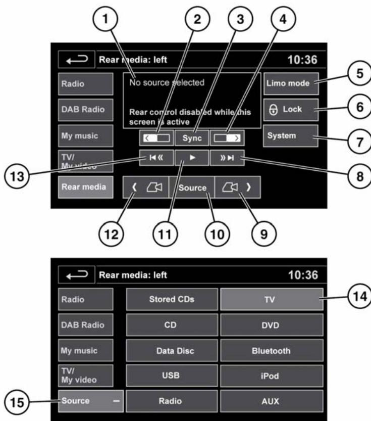
Toccare **Intratt. post.** sul menu principale Audio/video per selezionare la schermata di comando del sistema di intrattenimento posteriore.
