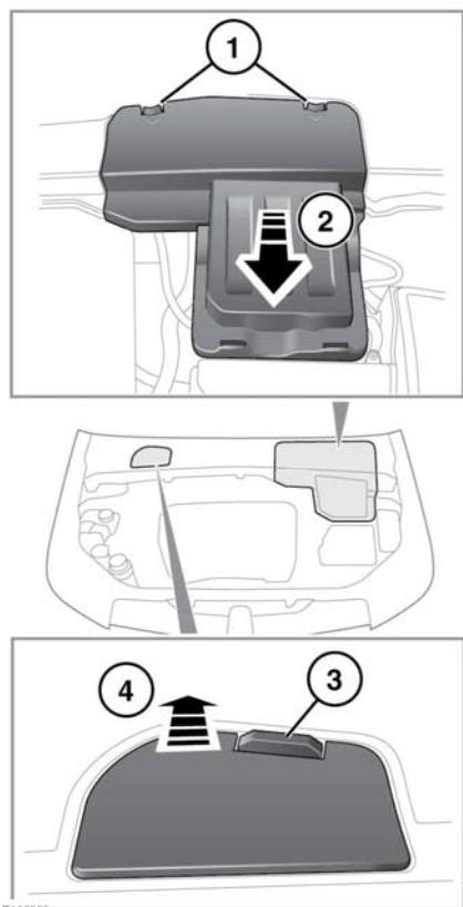
**Примечание:** Сначала освободите внутренний фиксатор на переднем краю крышки, это облегчит отсоединение остальных фиксаторов.
