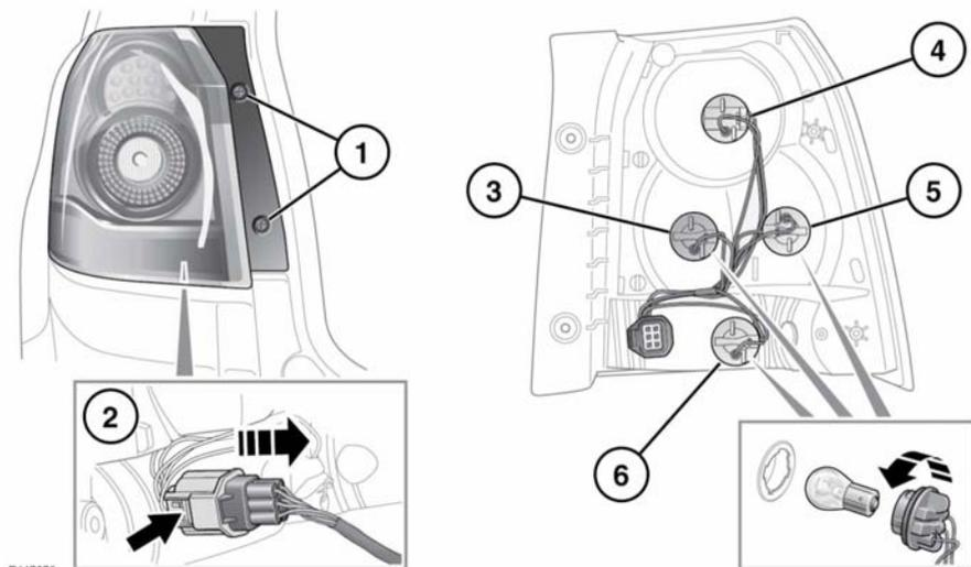
1. Открыв дверь багажного отделения, выверните два винта на внутренней кромке фонаря.
