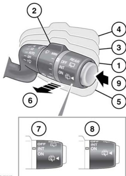
1. Режим автоматического обнаружения дождя - управление включением и скоростью работы щеток передних стеклоочистителей выполняется автоматически при наличии воды на стекле. При этом частота взмахов щеток выбирается в соответствии с преобладающими условиями. Чувствительность системы регулируется вращением кольца (2).
