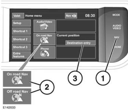
1. Аппаратная клавиша **NAV**: нажмите для входа в навигационную систему.
