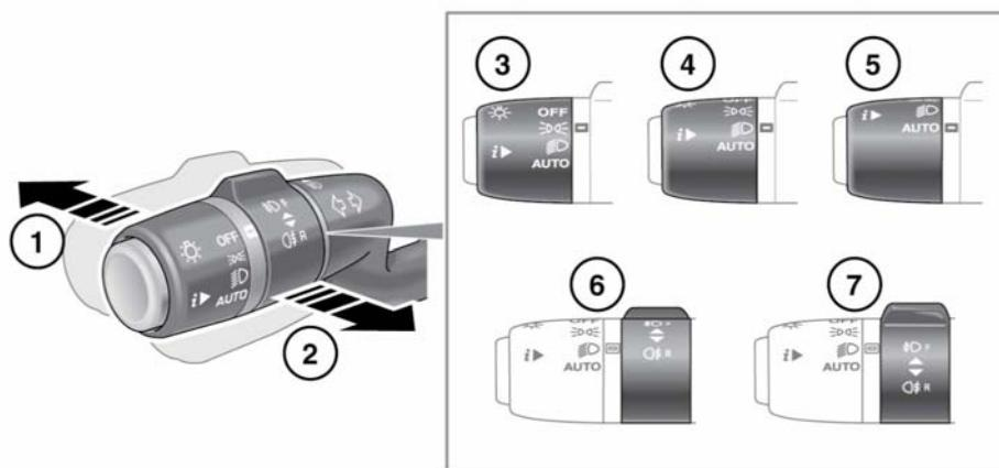
1. При включенных фарах нажмите переключатель от себя, чтобы включить дальний свет. Включится сигнализатор. См. 69, ДАЛЬНИЙ СВЕТ (СИНИЙ).
