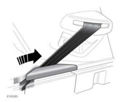
Per poter srotolare e ritrarre la copertura del vano di carico senza urtare la cintura di sicurezza, far passare la cintura di sicurezza nel fermaglio sul rivestimento, posizionato nella parte posteriore del vano di carico. Per maggiori informazioni sulle cinture di sicurezza dei sedili della terza fila, vedere 33, USO DELLE CINTURE DI SICUREZZA.
