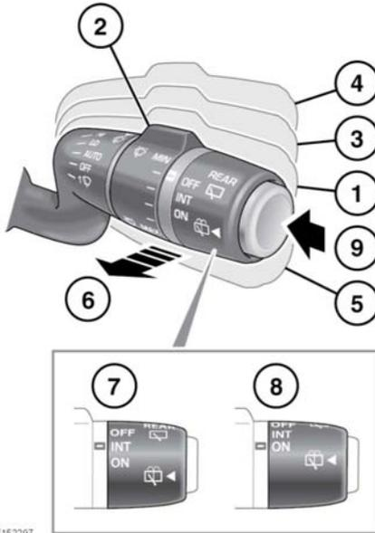
1. Modo automático de detección de lluvia: Los limpiaparabrisas delanteros responderán y se adaptarán automáticamente a condiciones ambientales lluviosas, de modo que se seleccionará la frecuencia de barrido adecuada en función de las condiciones reinantes. La sensibilidad del sistema se puede ajustar girando el mando (2).
