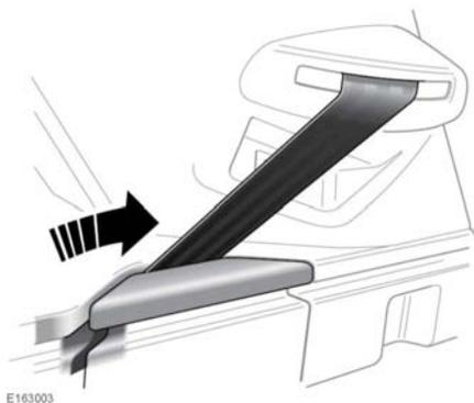
Para desenrollar y retraer correctamente la cubierta del maletero, sin que se enganche en el cinturón de seguridad, coloque el cinturón de seguridad en la abrazadera del guarnecido, situada en la parte trasera del maletero. Si desea obtener más información sobre los cinturones de seguridad de los asientos de la tercera fila, consulte **34, UTILIZACIÓN DE LOS CINTURONES DE SEGURIDAD.**
