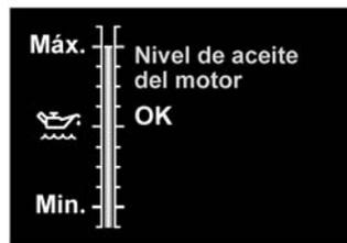
Si el nivel de aceite se encuentra dentro del margen necesario, se muestra el mensaje **Nivel de aceite del motor OK**. En este caso, no añada más aceite al motor.
