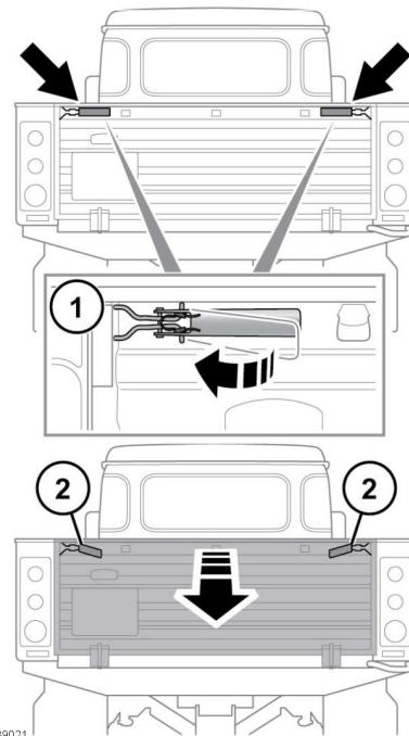
1. Die Riegel zu den Außenseiten des Fahrzeugs hin öffnen.
