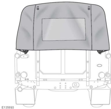
Das Verdeck-Heckfenster abrollen und zur Befestigung die beiden Reißverschlüsse herunterziehen.
