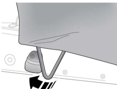
Das Verdeckseil in Schlaufen um die einzelnen Haken entlang den Fahrzeugseiten legen; vorn am Verdeck beginnen. Darauf achten, dass jede Schlaufe festgezogen wird, bevor die nächste Schlaufe gemacht wird.
