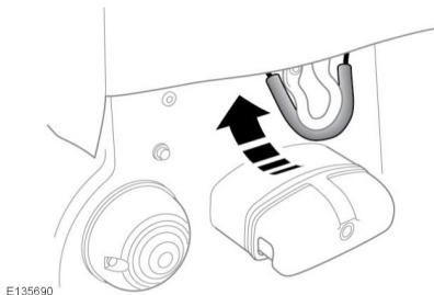
Beide Gummischlaufen ziehen und an den Haken über den Schlussleuchten befestigen.
