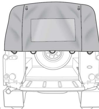
Bevor das Verdeck am Fahrzeug befestigt wird, muss es so aussehen wie in dieser Abbildung.
