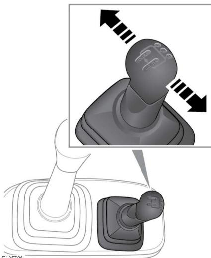
**Hoher Fahrbereich:** Auf allen normalen Straßen sowie in trockenem, ebenem Gelände zu verwenden.
