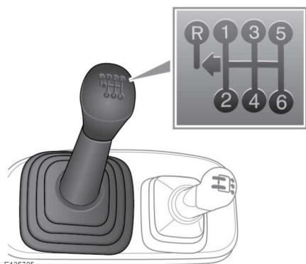
Die Kraftübertragung erfolgt über ein 6-Gang-Schaltgetriebe und ein Verteilergetriebe mit einem hohen und einem niedrigen Fahrbereich. Über ein Mittendifferenzial wird die Kraft zur Vorder- und zur Hinterachse übertragen, so dass der Allradantrieb permanent zur Verfügung steht.
