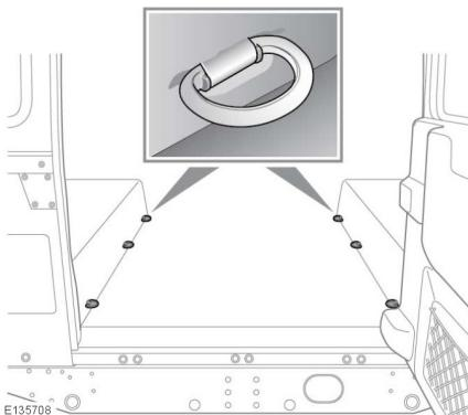
Bei einigen Fahrzeugen befinden sich im hinteren Kofferraumbereich Gepäckbefestigungsringe für die sichere Befestigung von Gegenständen.
