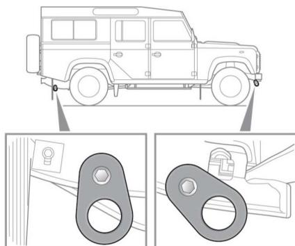
**⚠** Die Abschleppösen vorn und hinten am Fahrzeug sind nur zum Abschleppen auf der Straße bestimmt. Wenn sie zu anderen Zwecken verwendet werden, kann dies zu Schäden am Fahrzeug und zu schweren Verletzungen führen.
